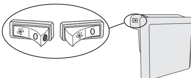
Když je ventilátor zapnutý, objeví se na spínači červená tečka.
