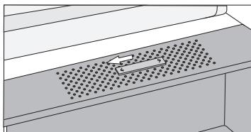
**Slider na levé straně:** otevřená ventilace, nižší vlhkost v přihrádce
