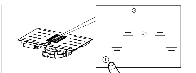
Stiskněte na 2 sekundy tlačítko On/Off pro zapnutí a aktivaci funkcí varné desky. Všechny Digity zobrazují **B** a Digity časovače zobrazují **C L**.
